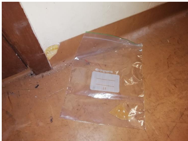
Kuva 75. Materiaalinäyte 83. Ullakko. IV-konehuone. Matto/liima.
