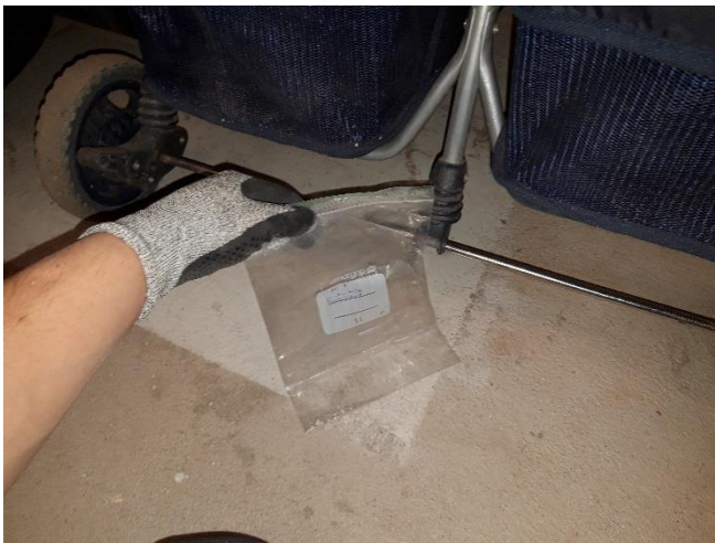
Kuva 9. Materiaalinäyte 9. Kellari. Lattia. Maali/tasoite.
