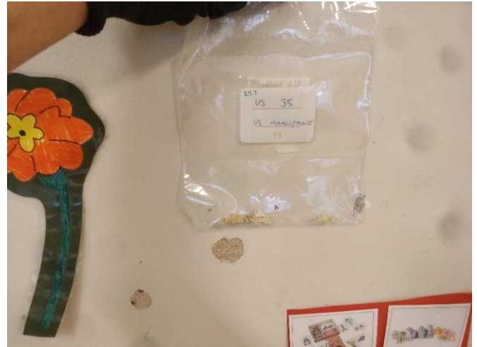
Kuva 34. Materiaalinäyte 35. 1.krs. Seinä. Maali/tasoite.
