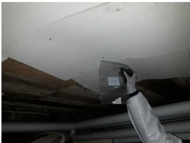
Kuva 1. Materiaalinäyte 1. Ryömintätila, katto, pahvi.
