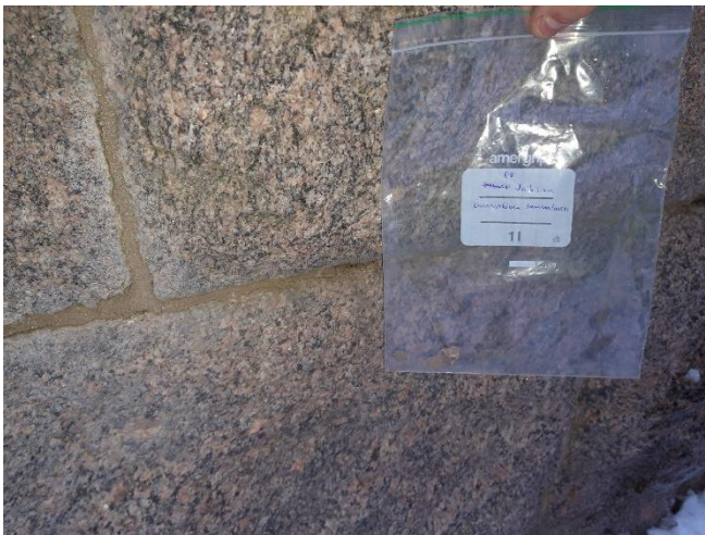
Kuva 63. Materiaalinäyte 68. Julkisivu. Sokkeli. Saumalaasti.
