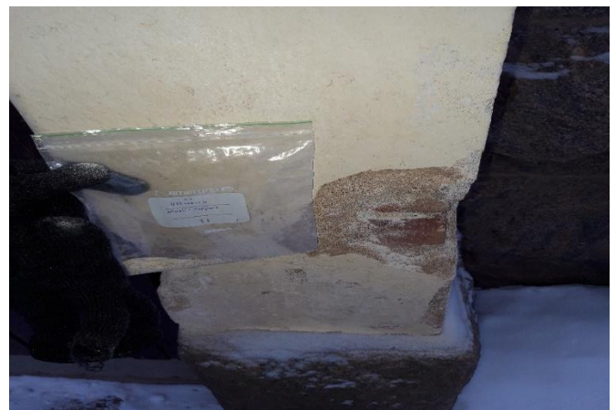
Kuva 60. Materiaalinäyte 65. Julkisivu. Seinä. Rappaus/maali/muurauslaasti.
