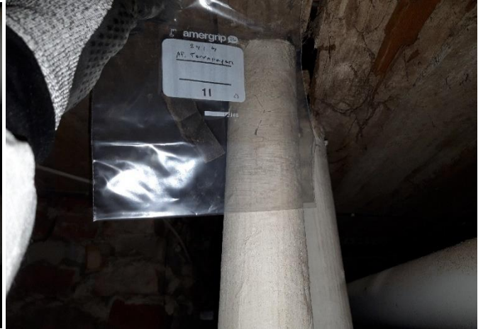
Kuva 4. Materiaalinäyte 4. Ryömintätila. Katto. Tervapaperi
