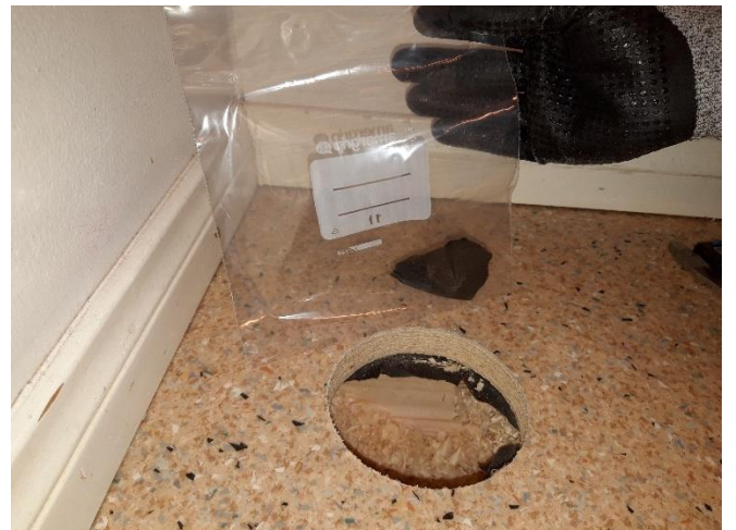
Kuva 68. Materiaalinäyte 73. 1.krs. Lattia. Tervapaperi.
