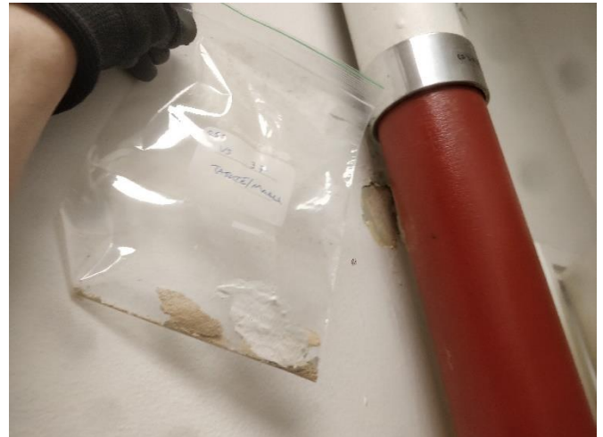
Kuva 36. Materiaalinäyte 37. 1.krs eteinen. Seinä. Maali/tasoite.
