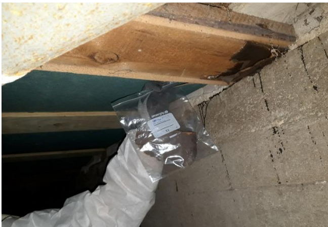
Kuva 7. Materiaalinäyte 7. Ryömintätila. Katto. Kuitulevy/tervapähvi.
