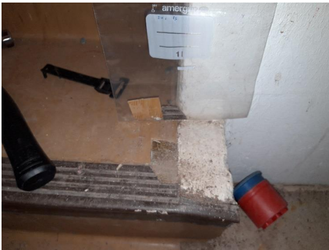
Kuva 15. Materiaalinäyte 15. Kellarin portaat. Matto/liima.
