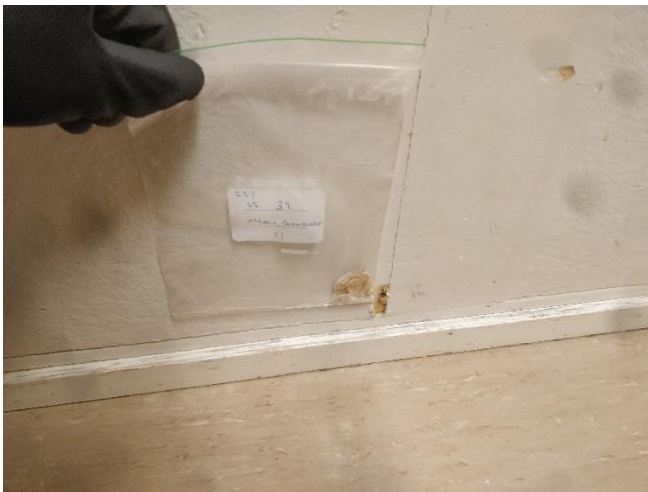
Kuva 33. Materiaalinäyte 34. 1.krs. Seinä. Maali/levy.
