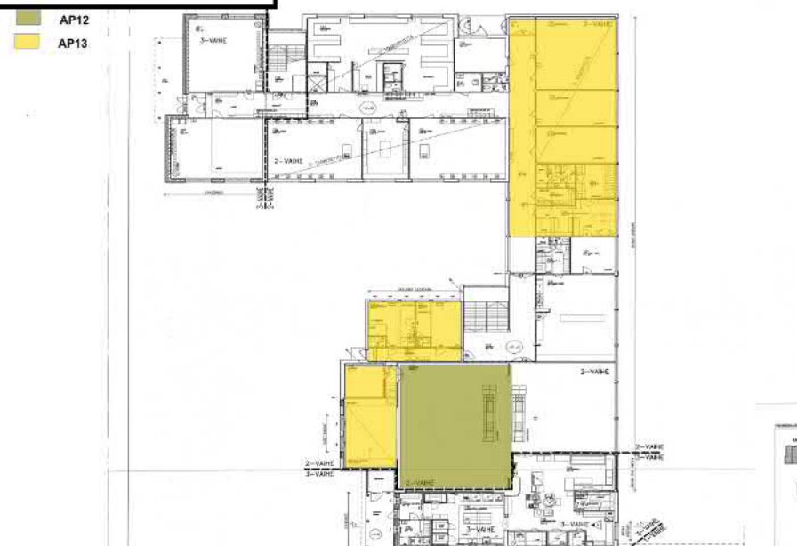
Kuva 55. B-osan 1. kerroksen alapohjarakenteiden sijainnit rakenneavausten perusteella.
