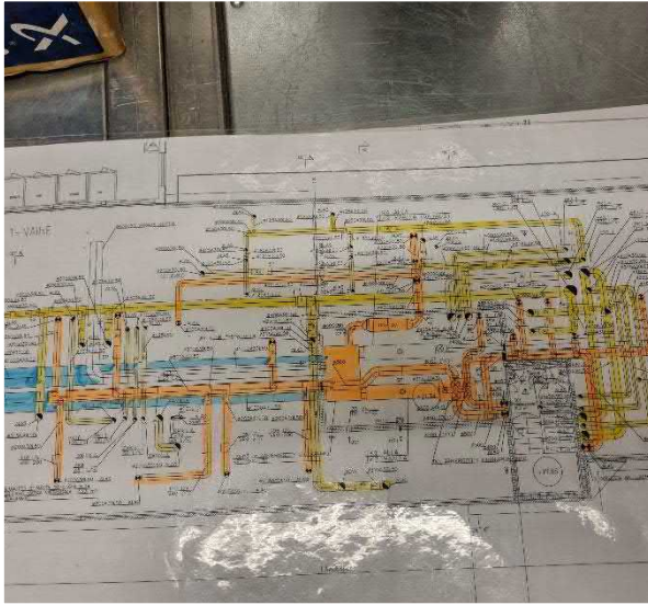
Kuva 162 IV-konehuoneen ja ullakon kanavointien periaatteet käyvät ilmi konehuoneesta löytyneestä iv-suunnitelmasta.
