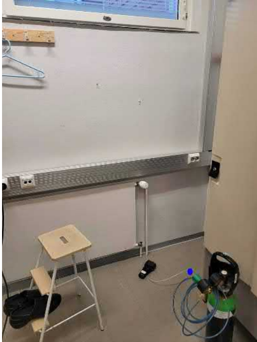
Kuva 29 Merkkiainekokeen syöttöpiste alapohjaan
