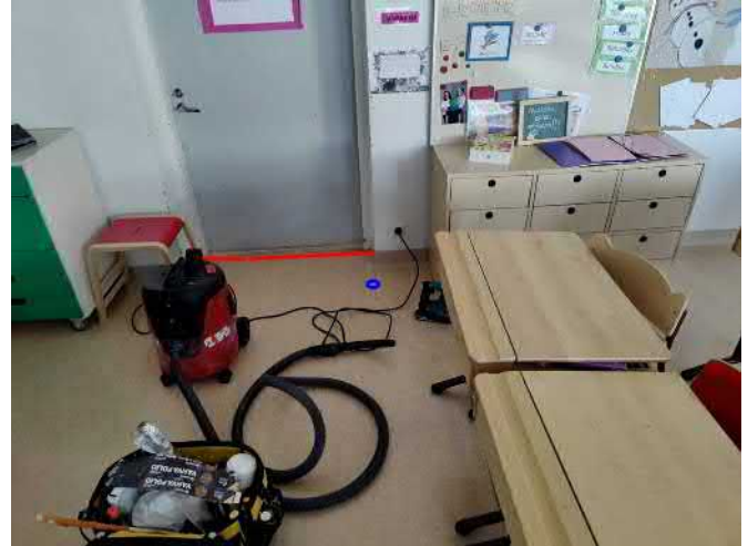
Kuva 59 Merkkiaineen syöttöpiste kynnyksen vieressä. Vuotoa kynnykseltä.
