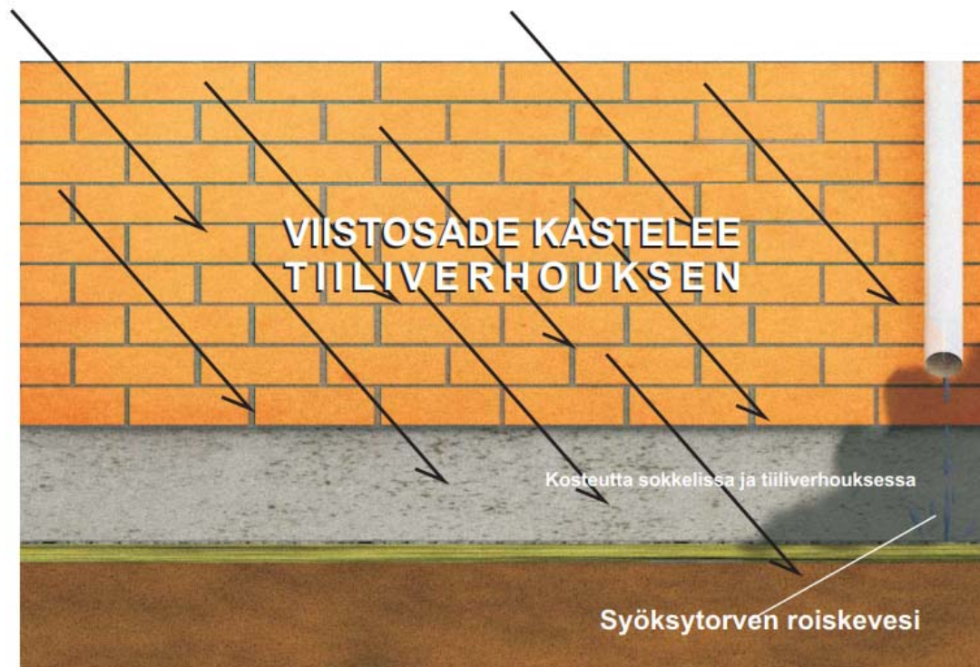
Viistosateen aiheuttama kosteuskuorma
